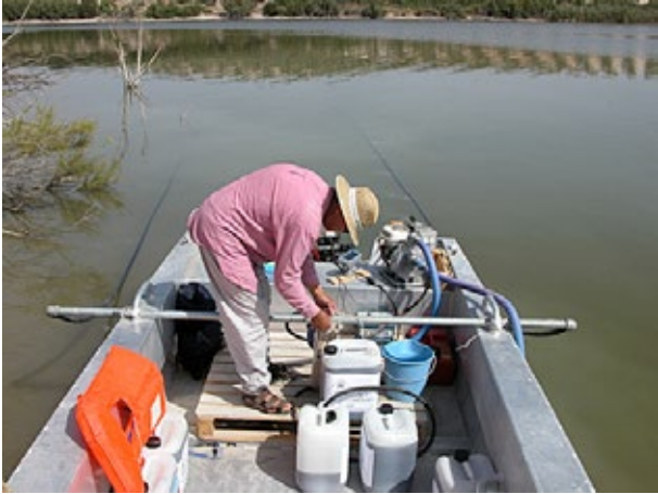
Bilde 2. I innsjøer benytter vi båter med pumper og slanger for utdosering av rotenon.
