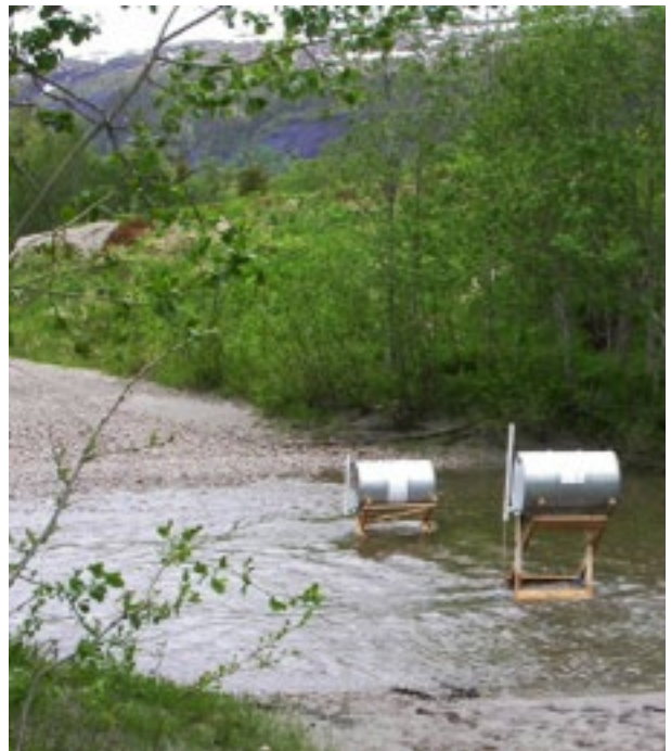
Bilde 5 og 6. I mindre bekker benytter vi dryppstasjoner som gir en konstant tilsetning av rotenon.
