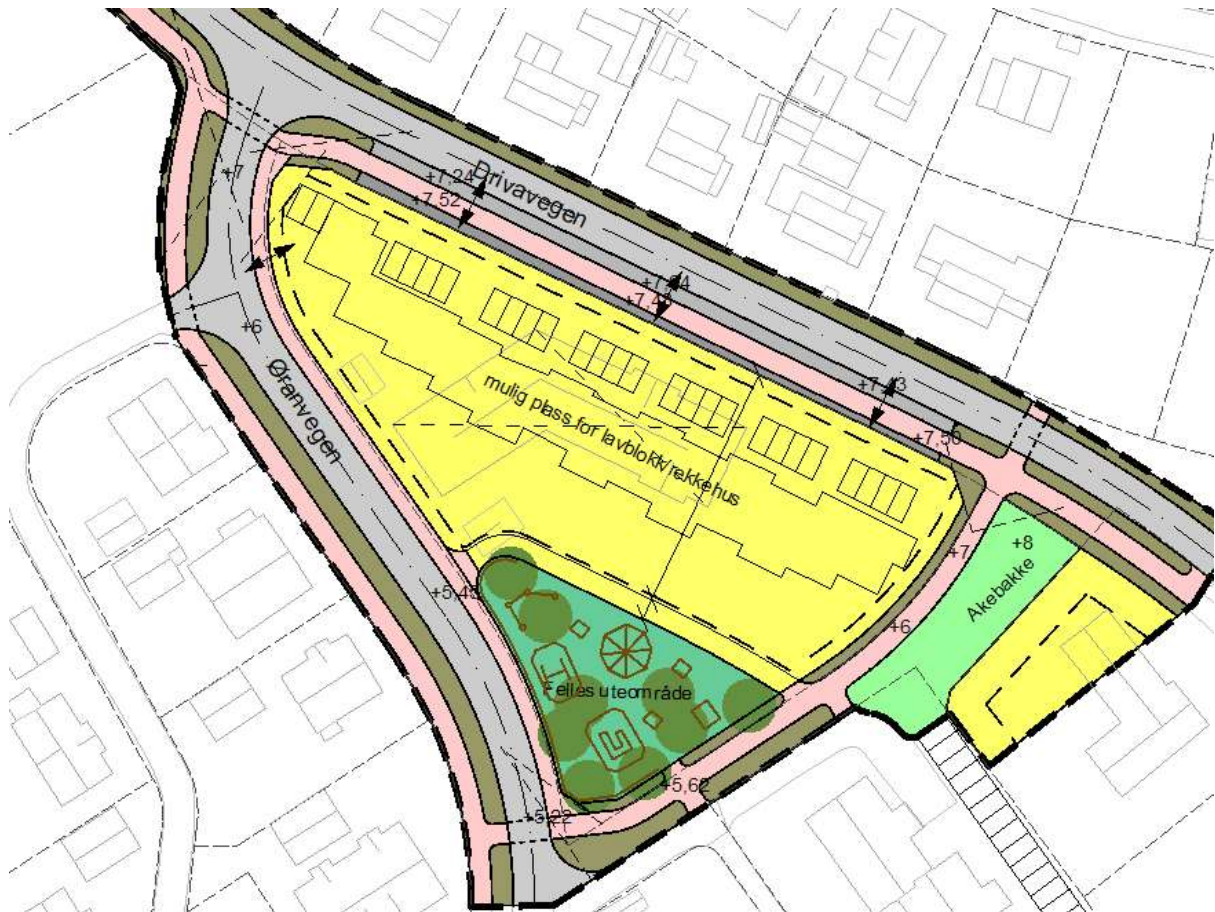
Illustrasjonsplan over mulig utforming av området med utendørs felles leke- og møteplass mot syd og boligbebyggelse med lavblokk/rekkehus og garasjer/parkering mot Drivavegen.
