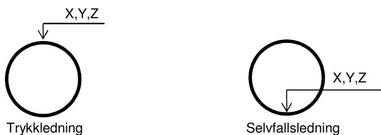
Figur 1. Måling av ledningshøyde.
