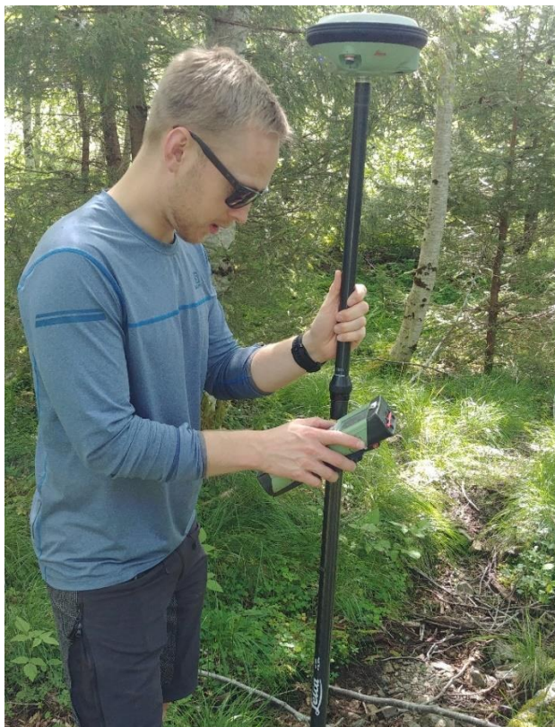
Figur 4 - Innmåling av vannveg
