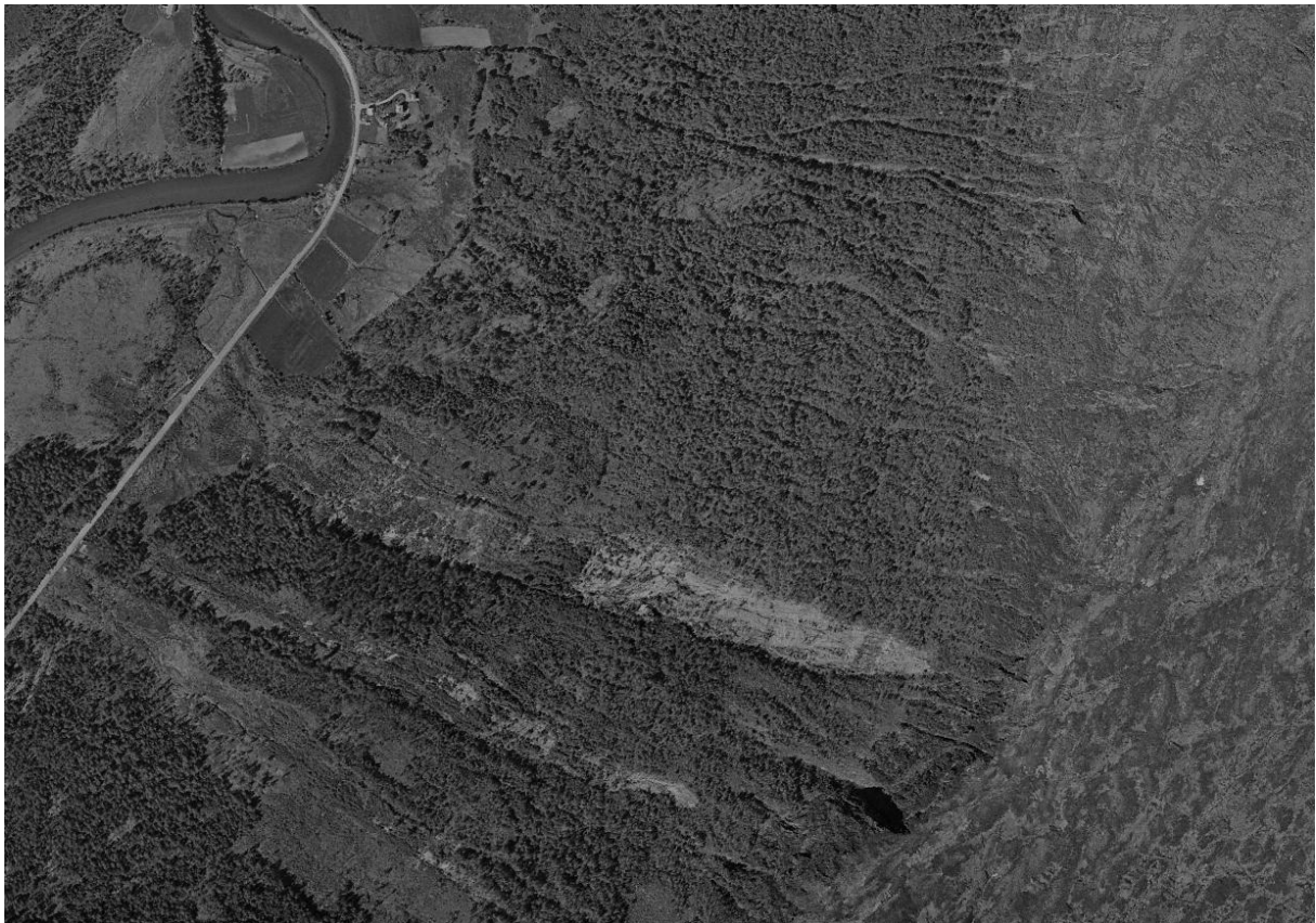
Figur 18. Flyfoto fra Ålvundfoss tatt i 1960. Bildet viser spor etter flere jordskred. I dag er disse skredløpene gjengrodd og ikke synlig i terrenget.
