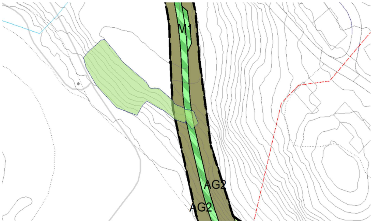
Figur 28 Utsnitt av alternativ A vestlige del. Registrert naturbeitemark er vist med lys grønn farge. Traseen og vegskulder kommer litt inn på enden av beitemarka. Det er samme trasevalg i dette området både for alternativ A, B1 og B2
