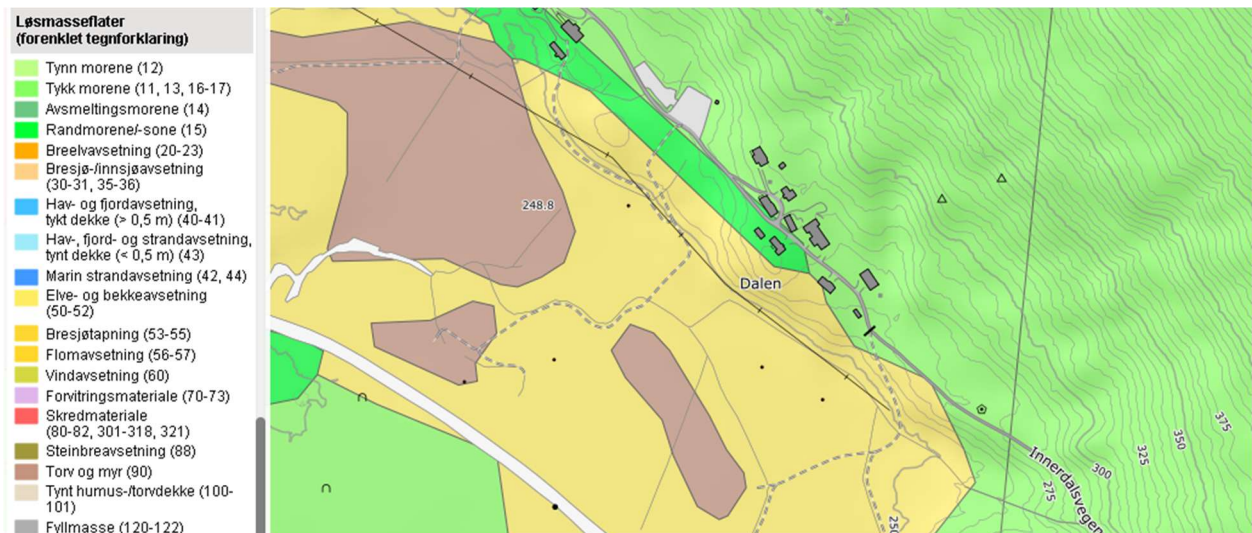
Figur 6 Utsnitt fra NGU løsmassekart. Gult er elve- og bekkeavsetninger. Grønt er morenematerialer.
